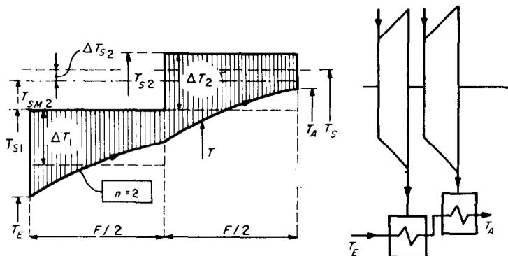
ABB. 3. Kondensation bei zwei verschiedenen Sattdampf temperaturen (Serieschaltung).
