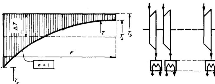
ABB. 2. Kondensation bei nur einer Sattdampf temperatur (Parallelschaltung).
