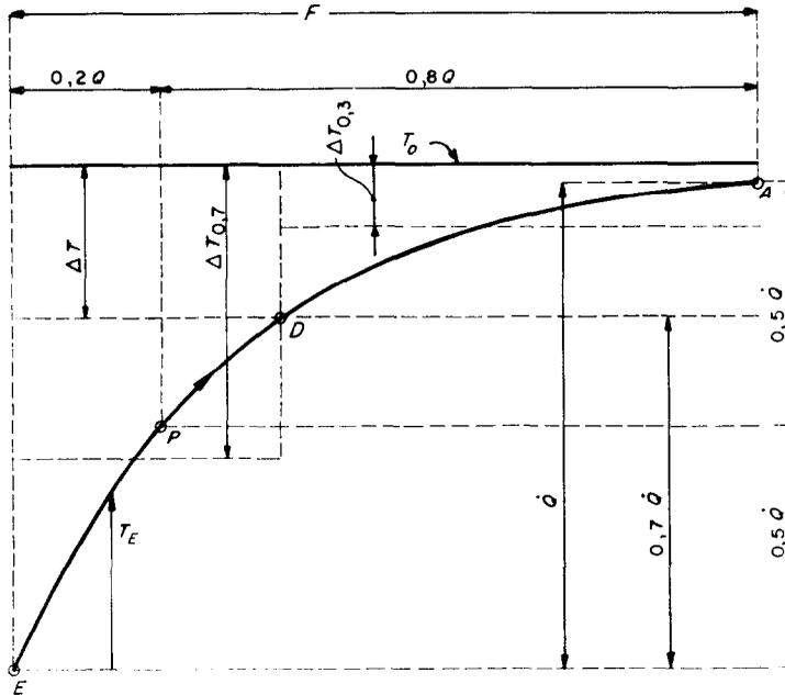
Abb. 1. Beispiel über die Verteilung des Irreversibilitätsgrades des Temperaturunterschiedes der Wärmeübertragung.
