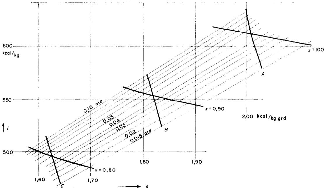
ABB. 6. Entspannungen bei drei verschiedenen Dampfgehalten und einem thermodynamischen Wirkungsgrad von 85 Prozent.
