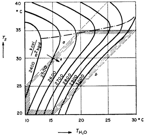
ABB. 5. Wärmedurchgangszahl  $k$  in kcal/grd h m<sup>2</sup> eines wassergekühlten Kondensators in Funktion der Wasser- und der Sattdampf Temperatur  $T_{H_2O}$  bzw.  $T_S$  in °C.
