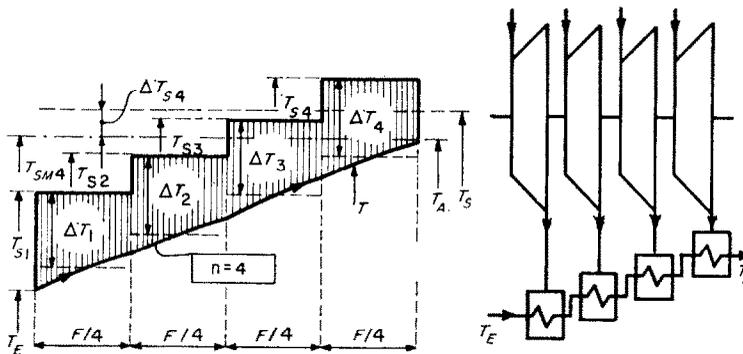
ABB. 4. Kondensation bei vier verschiedenen Sattdampf­temperaturen (Serieschaltung).
