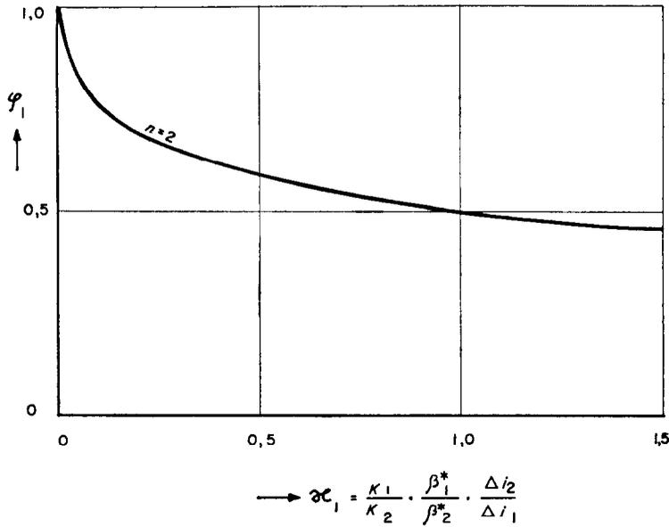
ABB. 8. Dimensionslose Oberfläche  $\varphi_1$  bei zwei Kondensatoren in Funktion der Variablen  $\kappa_1$ .
